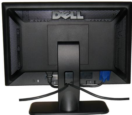
Dopo aver fissato tutti i cavi necessari al monitor ed al computer, (fare riferimento a [Collegamento del Monitor](#) per il collegamento dei cavi,) usare il passacavi per organizzare i cavi in maniera ordinata, come mostrato sopra.
